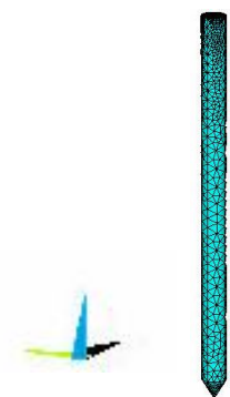
图4 静力触探探头网格划分图
